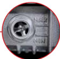
Visor del nivel de aceite de la bomba de vacío.
