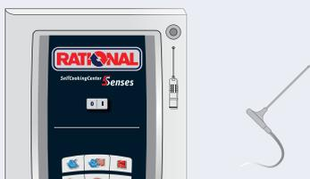
En caso necesario la sonda térmica se puede conectar por la parte exterior del aparato mediante la oportuna caja de conexión.
