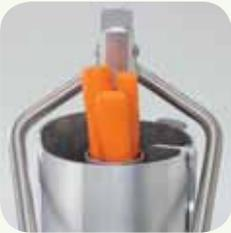
Tolva cilíndrica de Ø 58 mm para un corte uniforme de los productos alargados
